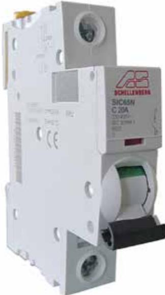
Automatski osigurač obezbeđuje zaštitu električnih instalacija i potrošača usled pojave struje preopterećenja, kao i struje kratkog spoja. Pri priključivanju automatskog osigurača treba paziti na polaritet, jer se pogrešnim priključivanjem osigurač uništava.
