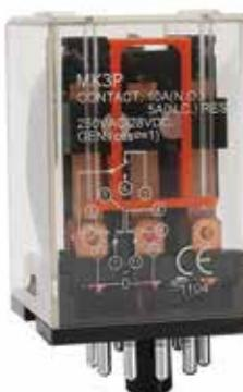
**Industrijski relaj 11PINA** 3 para kontakata. Uredaj namenjen za ugradnju u table za automatizaciju i signalizaciju. Uglavnom se koristi za davanje naredbi izvršnom mehanizmu. Kontaktne površine izvedene od elektrolitickog bakra prekrivenog srebrom.
